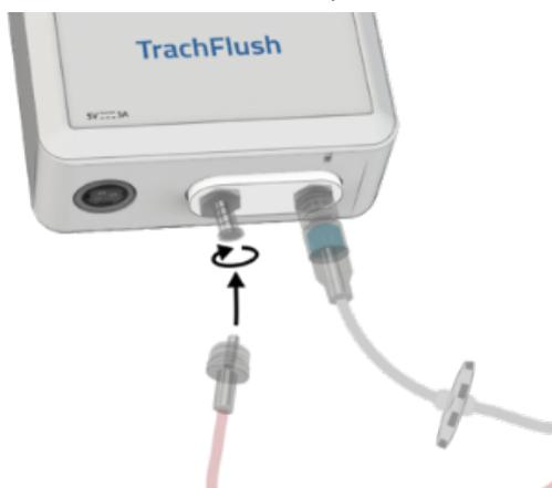
Figura 4: Connettività del dispositivo, collegamento dei tubi di ventilazione
